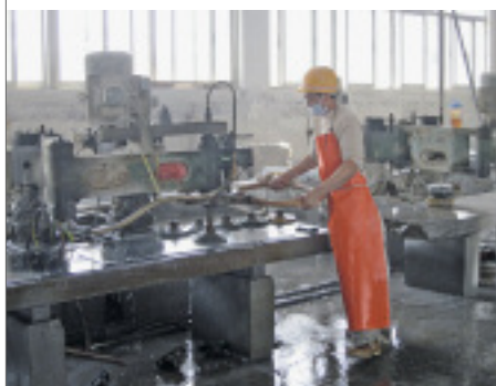
Arbeiter mit Schutzausrüstung beim Polieren
