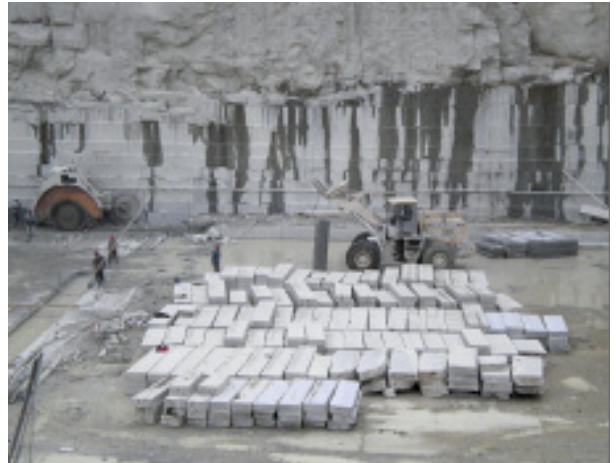
Blockgewinnung mit gleisgeführten Sägen
