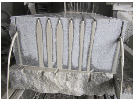
Blocksäge zum Schneiden der Granitblöcke.
